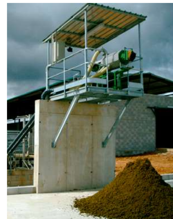
Imagen 3.1. Separador de tornillo-prensa filtrando purín.
