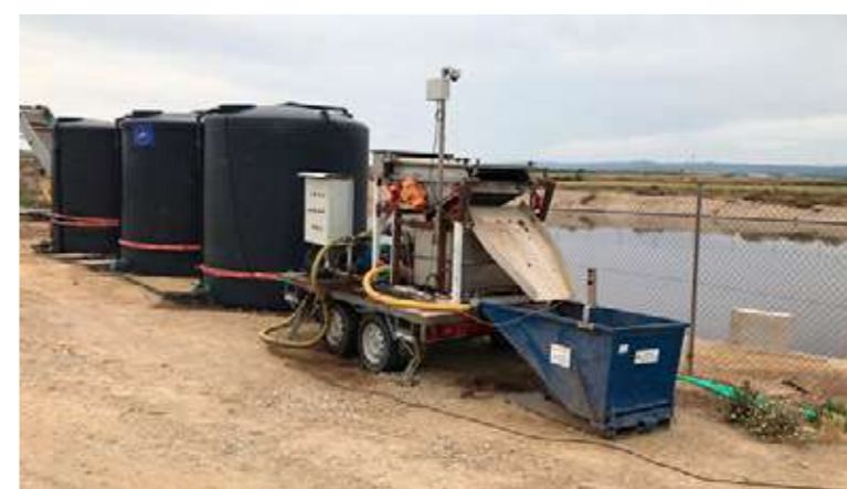
Imagen 5.1. Separadores sólido/líquido instalados en la granja de porcino de engorde (ES-SI-F1) que suministraron el purín para los ensayos demostrativos en la finca de Torremira, en Cinco Villas (ES-SI-G).
