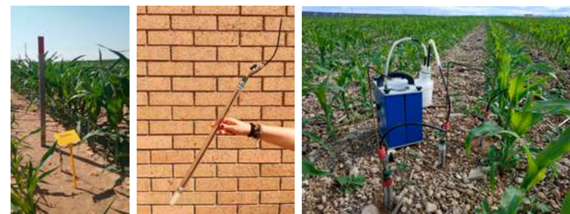
Imagen 4.5. Sondas de succión instaladas en las parcelas demostrativas del proyecto LIFE ARIMEDA.
