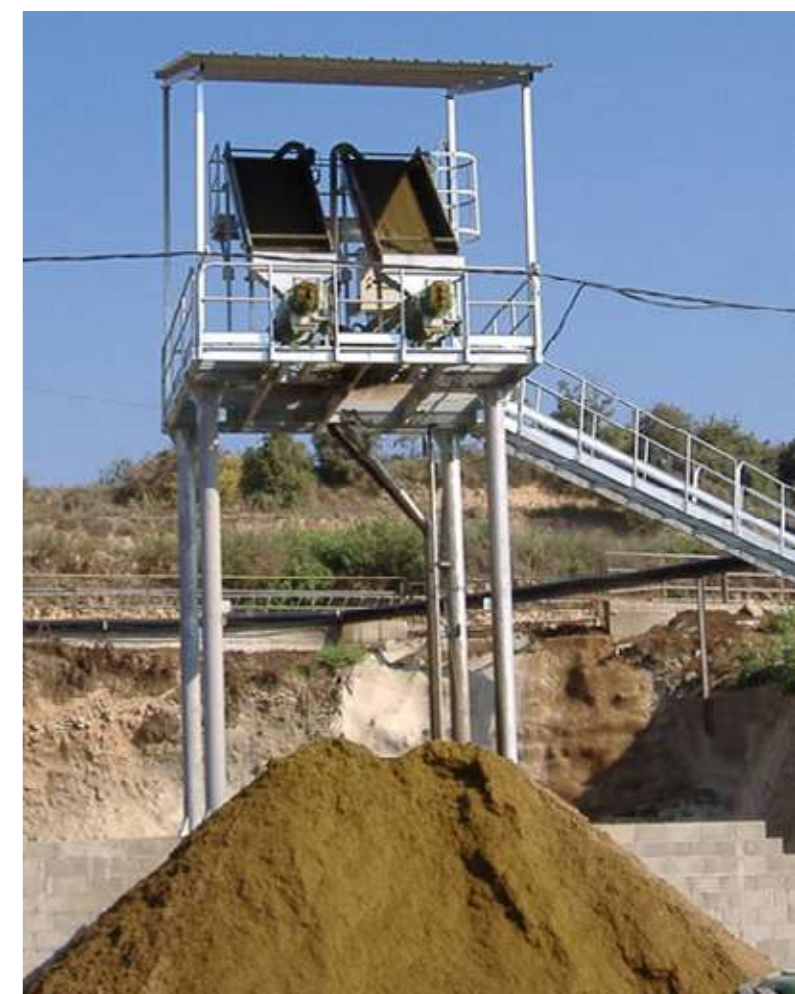
Imagen 3.2. Separador de rampa-tamiz con tornillo prensa.
