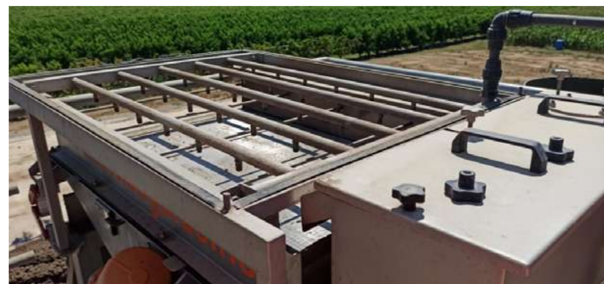
Imagen 3.5. Tamiz vibrador con tubos de limpieza automática.
