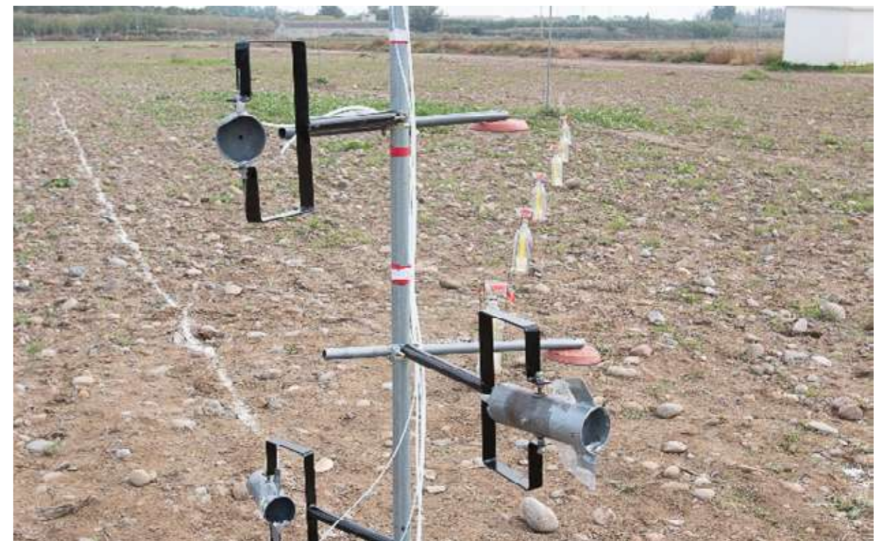
Imagen 4.2. Ensayo de comparación de métodos de medición de emisiones de amoníaco en las instalaciones experimentales del CITA (Zaragoza, España).
