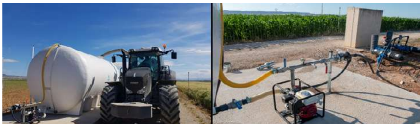
Imagen 3.9. Llenado del tanque de almacenamiento de fracción líquida en campo e inyección al sistema de goteo.
