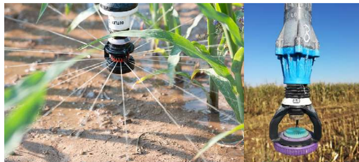
Imagen 3.11. Boquillas de riego instaladas en las parcelas demostrativas con riego con pivots del proyecto LIFE ARIMEDA en Aragón (izda.) y en Lombardía (dcha.).
