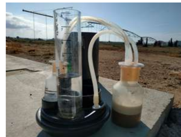
Imagen 4.8. Análisis de nitrógeno amoniacal de la fracción líquida de purín utilizando un equipo Quantofix® en La Melusa (Aragón, España).
