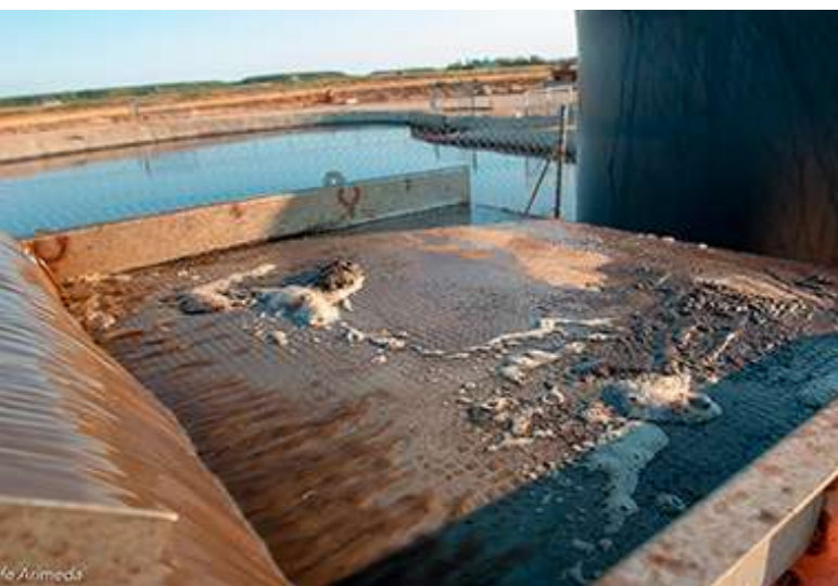
Imagen 3.3. Separadores de tamiz vibratorio para purín (izda.) y para digerido (dcha.) trabajando.
