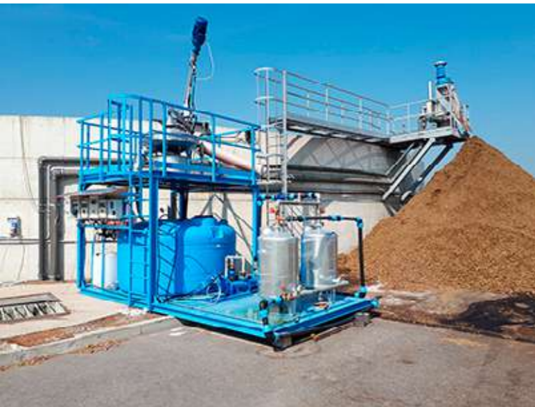
Imagen 6.2. Sistema de filtrado para proporcionar la fracción líquida de digerido para el riego por goteo instalado en la finca de transferencia Goteo 1 en Lombardía (Italia).
