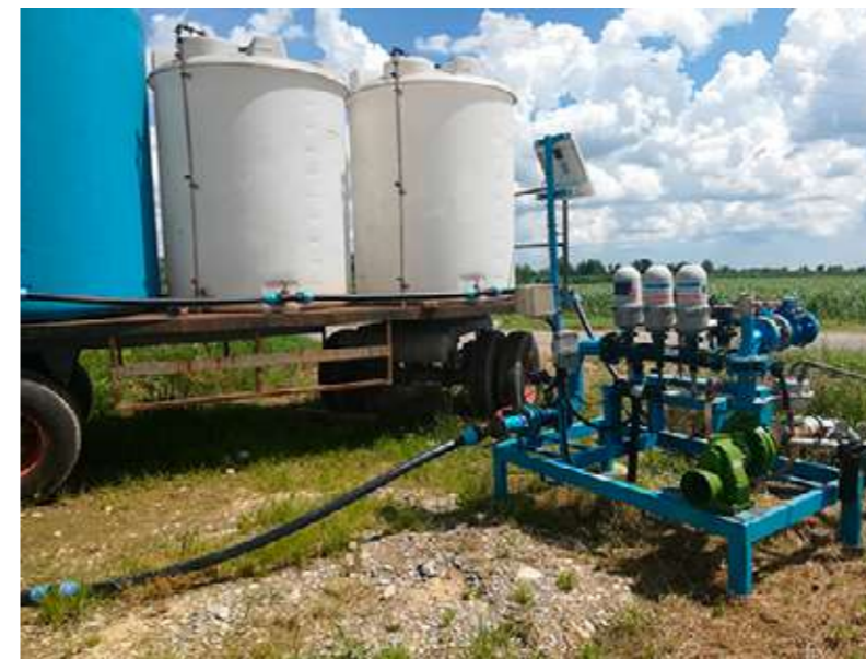
Imagen 6.4. Almacenamiento de la fracción líquida del purín y sistema para su inyección en el riego en la parcela de transferencia Goteo 1 en Lombardía (Italia).
