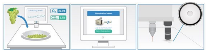
Funcionamiento de la tecnología PERFOTEC (Fuente: www.perfotec.com )
