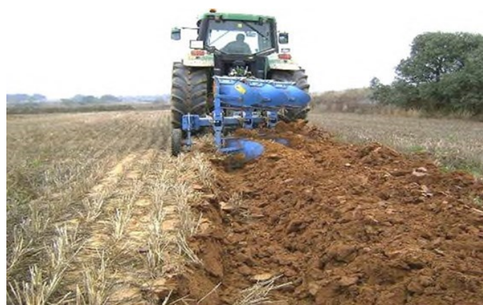
Impacto de una labor tradicional con arado de vertedera sobre la superficie y capa arable del suelo en un cultivo de cereal de invierno.
