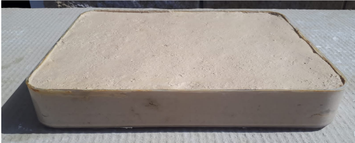
Foto 3a. Molde y mortero para realizar Panel Aislante Vitrolan Nature.
