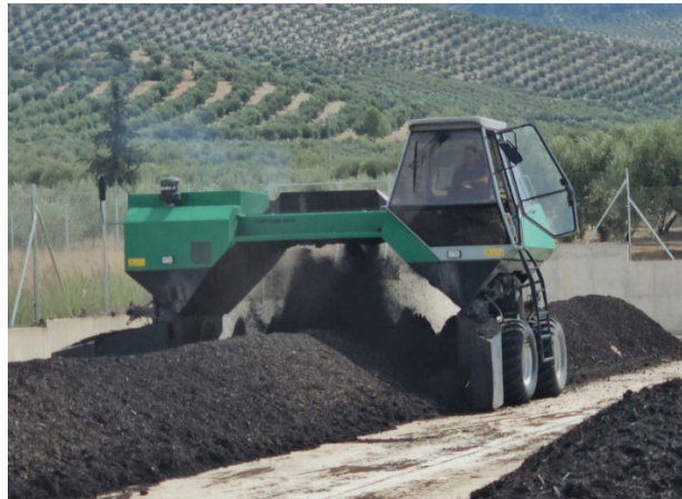
Figura 15. Sistema de pilas volteadas en la Planta de Puerta de Villas (a) y volteadora mecánica para la aireación del sustrato (b). Fuente: Oleovista.com (2025)
