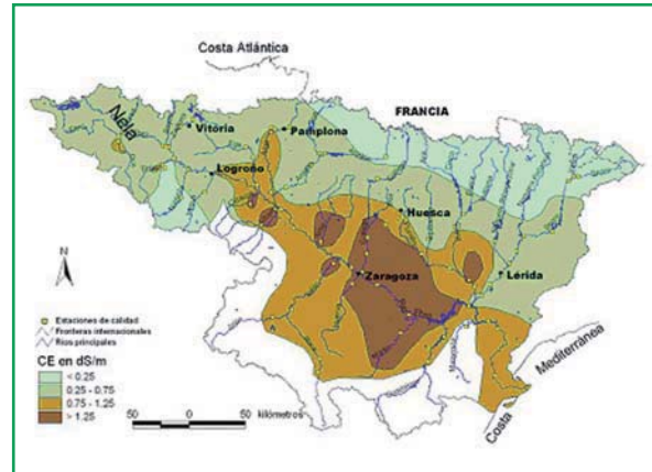
Figura 4. Isolinias de salinidad (CE, dS/m) de las aguas superficiales de la cuenca del Ebro.
