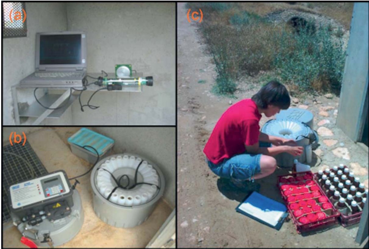
Figura 3. Equipos de (a) medición del caudal (Thalimedes), (b) toma de muestras de agua automático y (c) labores de recogida de las muestras de agua.
