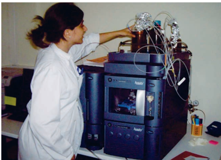
Figura 2: Detalle del cromatógrafo líquido con detector de masas (triple cuadrupolo) para la confirmación de DON en las muestras.
