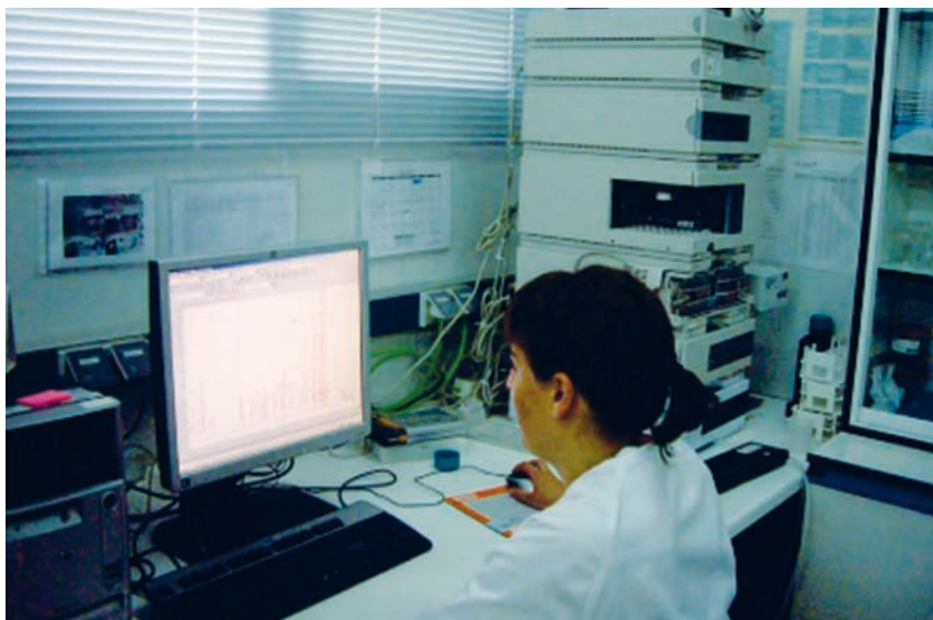
Figura 1: Detalle del cromatógrafo líquido con detector de red de diodos (LC-DAD) para la determinación de deoxinivalenol (DON) en las muestras.
