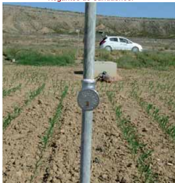
Fotografía 1. Transductor de presión y su data logger instalado en el tubo porta aspersor de una parcela cobertura total de aspersión en la Comunidad de Regantes de Candasnos.
