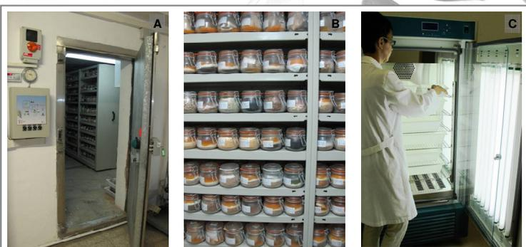
Figura 1. Cámara de conservación del Banco de Germoplasma de Especies Hortícolas de Zaragoza (BGHZ) a -18°C (A), semillas en frascos herméticos con gel de sílice (B) y cámara utilizada para las pruebas de germinación en condiciones controladas (C).
