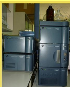
Fig. 3. Procedimiento de extracción e identificación de capsicinoides a partir de frutos de pimiento 'Bode'. (A) Método de extracción de capsicinoides mediante ultrasonidos; (B) Equipo UPLC-UV utilizado para la identificación de capsicinoides.
