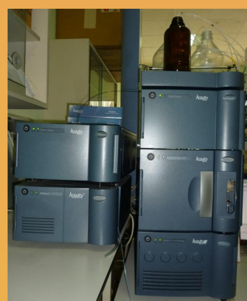
Fig. 3. Procedimiento de extracción e identificación de capsicinoides a partir de frutos de pimiento 'Naga Jolokia'. (A) Método de extracción de capsicinoides mediante ultrasonidos; (B) Equipo UPLC-UV utilizado para la identificación de capsicinoides.
