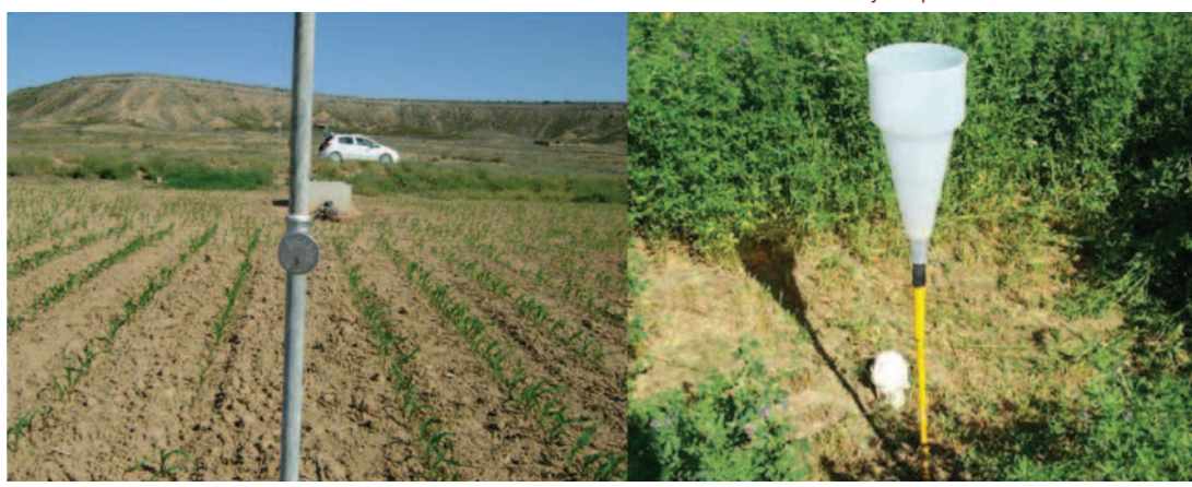
Fotografía 4 (izq). Transductor de presión instalado en un tubo porta-aspersor para la medida de la presión de funcionamiento a lo largo de las evaluaciones de riego. Fotografía 5 (dcha). Pluviómetro de plástico con una abertura de 160 mm utilizado en las evaluaciones de la cobertura fija experimental.
