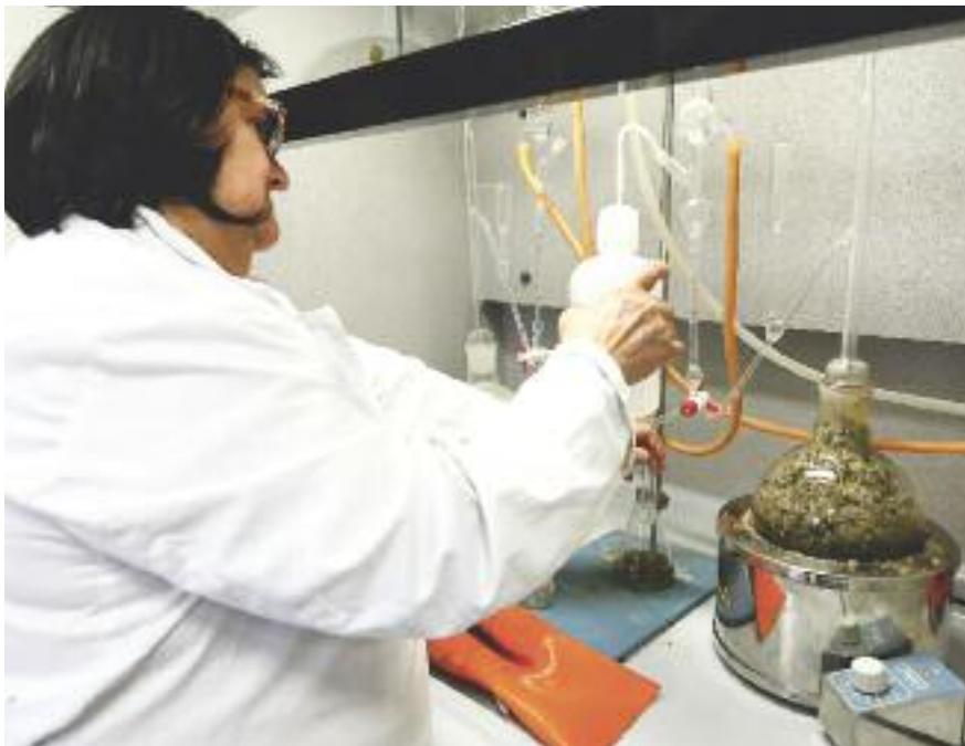
La destilación se lleva a cabo por arrastre de vapor en las instalaciones de la Fundación Térvalis
