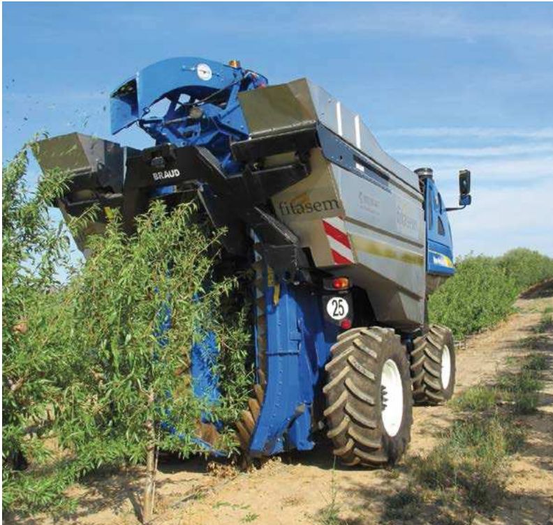
Cosechadora cabalgante de almendras utilizadas en sistemas intensivos.
