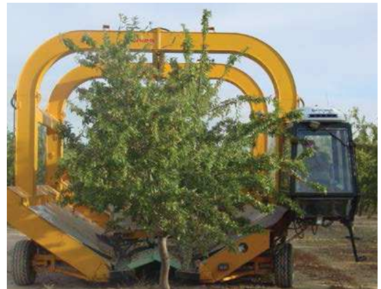
Cosechadora cabalgante utilizada en sistemas semi-intensivos de almendro.
