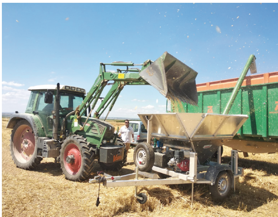
Sistema de remolque pesador (Cooperativa Virgen de la Oliva, Ejea de los Caballeros, Zaragoza) para facilitar el pesaje de parcelas experimentales de gran superficie.
