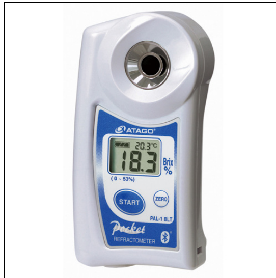
Figura 3.20. Refractómetro digital utilizado (Imagen de www.Atago.net ).
