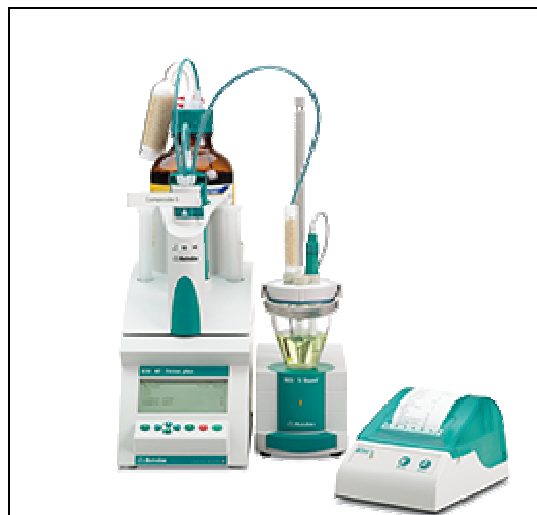
Figura 3.21. Valorador digital utilizado (Imagen de www.metrohm.com ).
