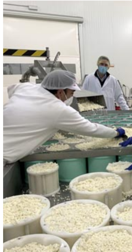
Relleno de los moldes octolobulados
