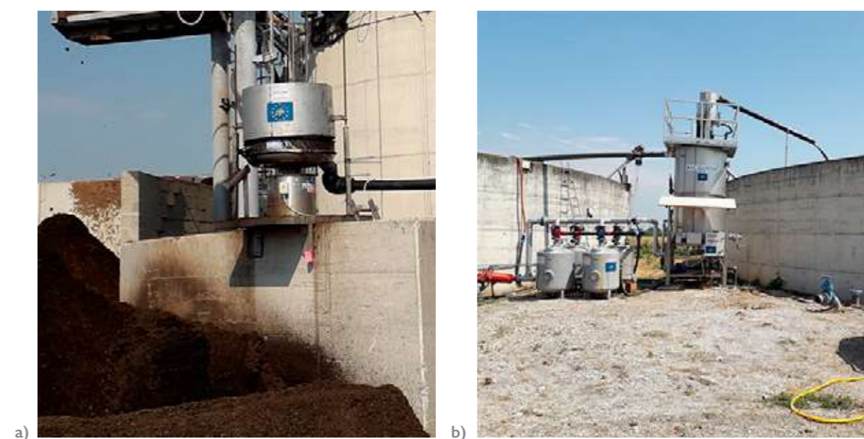
Foto 6.1. Vibrovaglio (a) e microfiltro (b) utilizzati per la filtrazione del digestato in Lombardia (Italia).
