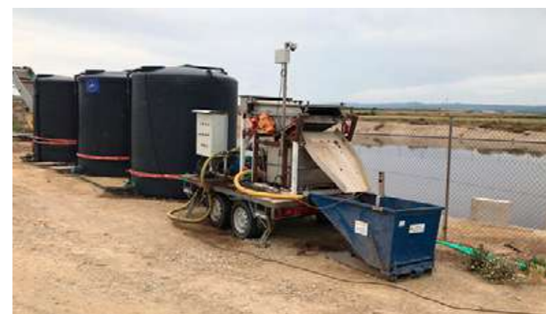
Foto 5.1. Separatori solido/liquido, prototipo pivot (a sinistra) e prototipo a goccia (a destra) nell'allevamento 1 (ES-S1-F1) che ha fornito la frazione liquida per il campo dimostrativo a Torremira a Cinco Villas (ES-S1-D).
