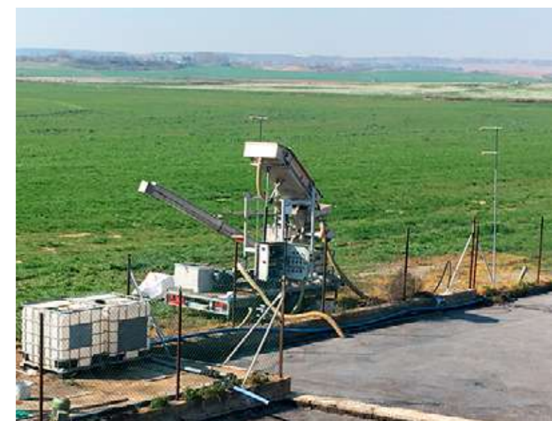
Foto 5.2. Separatore solido/liquido per pivot e lagone di stoccaggio della frazione liquida presso l'allevamento 3 (ES-S2-F3) che forniscono frazione liquida ai campi dimostrativi a La Melusa a La Litera (ES-S2-P, ES-S2-D).
