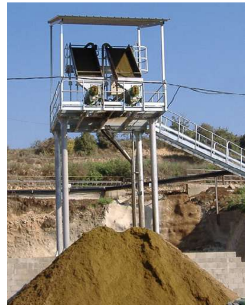
Foto 3.2. Separatore con vaglio inclinato e vite elicoidale.
