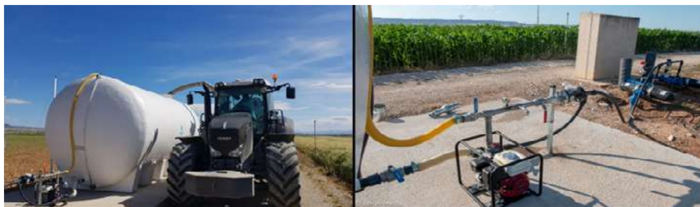
Foto 3.9. Riempimento del serbatoio di stoccaggio della frazione liquida in campo e iniezione nel sistema a goccia.
