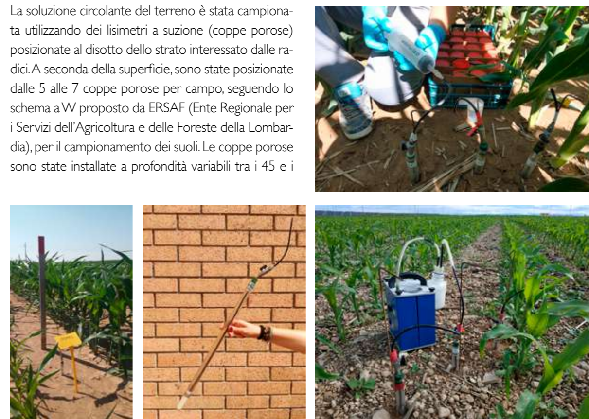
Foto 4.5. Lisimetri a suzione (coppe porose) installati negli appezzamenti LIFE ARIMEDA.
