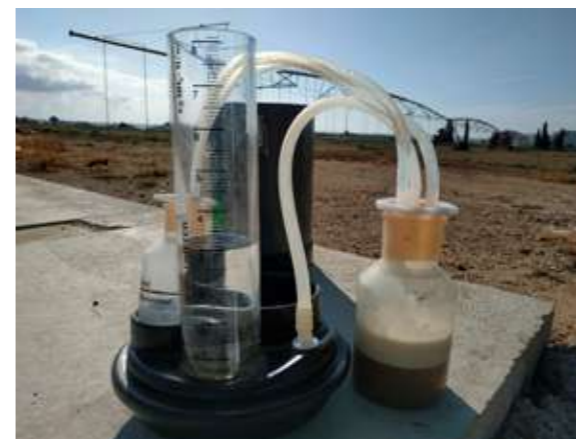
Foto 4.8. Analisi rapida del contenuto di azoto ammoniacale nella frazione liquida di un liquame suino utilizzato per la fertirrigazione con Quantofix® presso La Melusa (Aragona, Spagna).
