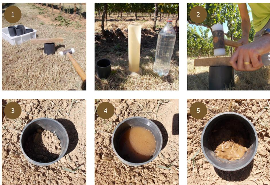
Figura 7. Diferentes fases del ensayo de medición de la velocidad de infiltración de agua:
