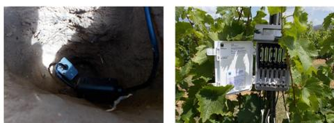
**Figura 3.** Sensor para medida de contenido de humedad del suelo (izquierda) y registrador de datos (derecha).
