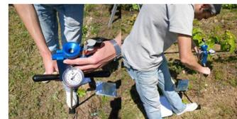
**Figura 4.** Medida del potencial hídrico de tallo a mediodía utilizando una cámara de presión.
