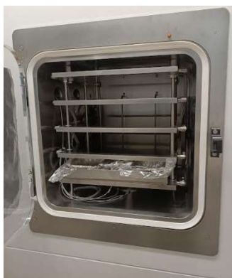
Figura 4.3. Liofilizador (Telstar; Terassa, España) empleado para la concentración de los extractos.
