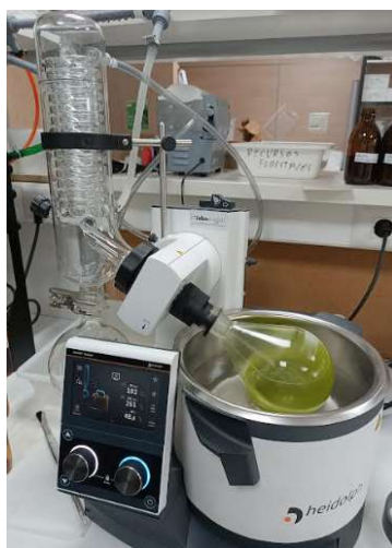
Figura 4.2. Evaporador rotativo empleado para la evaporación de los extractos vegetales.
