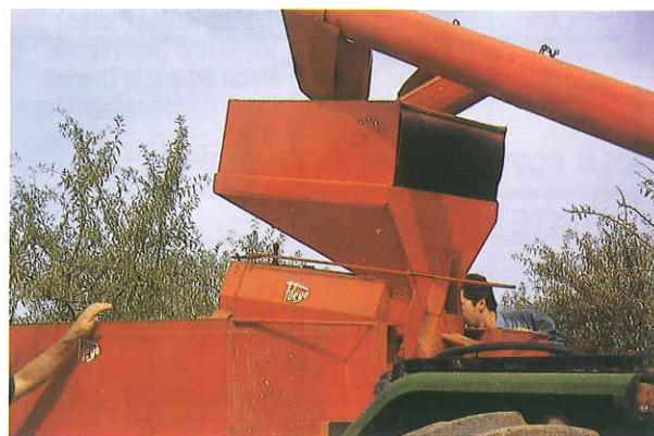
Detalle de la tolva de recepción
