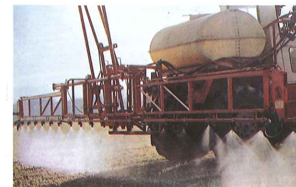
La regulación y limpieza del pulverizador son fundamentales para una correcta aplicación de herbicidas.
