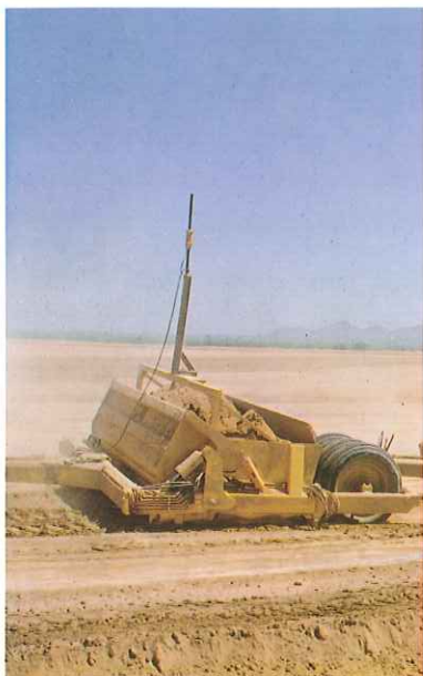
Niveladora con receptor de rayo laser sobre el mástil hidráulico durante la operación de nivelación.
