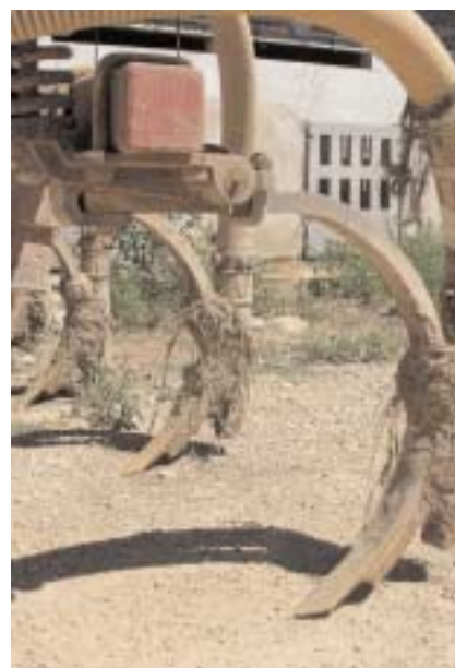
Apero para aplicación localizada de purín con reja e inyector. (Foto: F. Iguacel)
