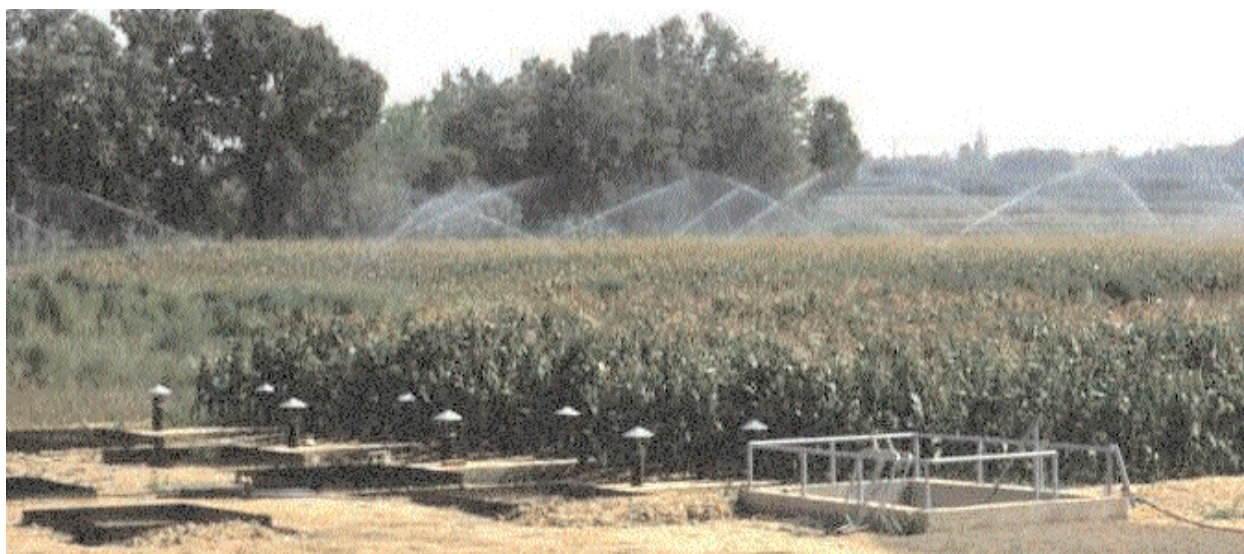
Instalación de lisímetros de drenaje.
