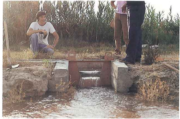
Foto 2. Aforo del caudal de una acequia.
