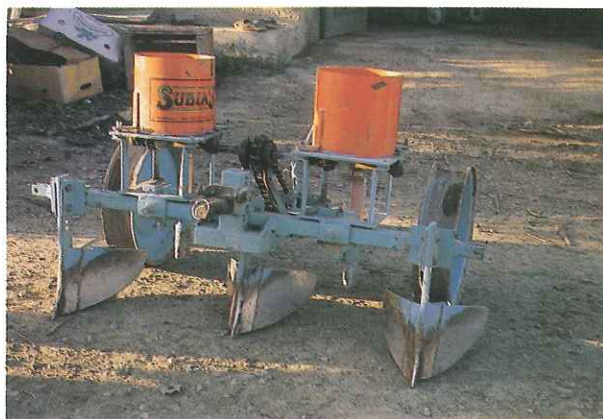
Foto 2. Sembrador a utilizada en la siembra directa de borraja.
