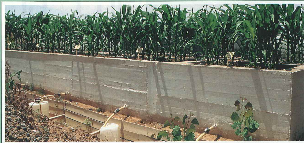
Maíz. Ensayo realizado en el Servicio de Investigación Agroalimentaria de la DGA para evaluar el lavado de nitrato en cultivo de maíz.
