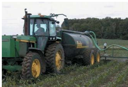
Figura 7. Esparcidor en bandas. Aplicación en cobertera sobre un cultivo de maíz. (Cortesía D. Hilborn, OMAF, Ontario, Canada)
