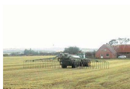
Figura 8. Sistema de mangueras colgantes. (Cortesía D. Hilborn, OMAF, Ontario, Canada)
