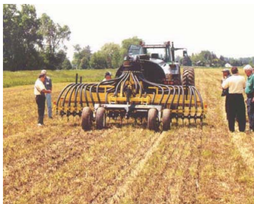
Figuras 3 y 4. Aplicación por inyección superficial. (S. Bittman, cortesía de Agriculture and Agri-Food Canada, con el permiso de Public Works and Government Services Canada, 2000).
