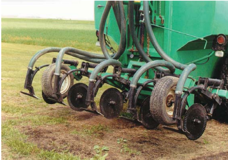
Figura 4. Aplicación por inyección profunda. (S. Bittman, cortesía de Agriculture and Agri-Food Canada, con el permiso de Public Works and Government Services Canada, 2000).
