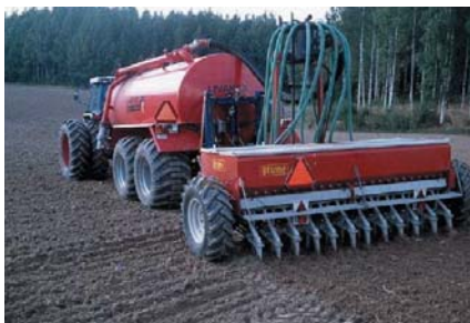
Figura 6. Inyección combinada con siembra. (Cortesía P. Kapuinen, Agrifood Reserch, Finland).
