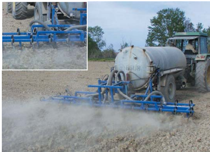
Figura 2 Aplicación de purín con máquina incorporadora en los ensayos realizados.
