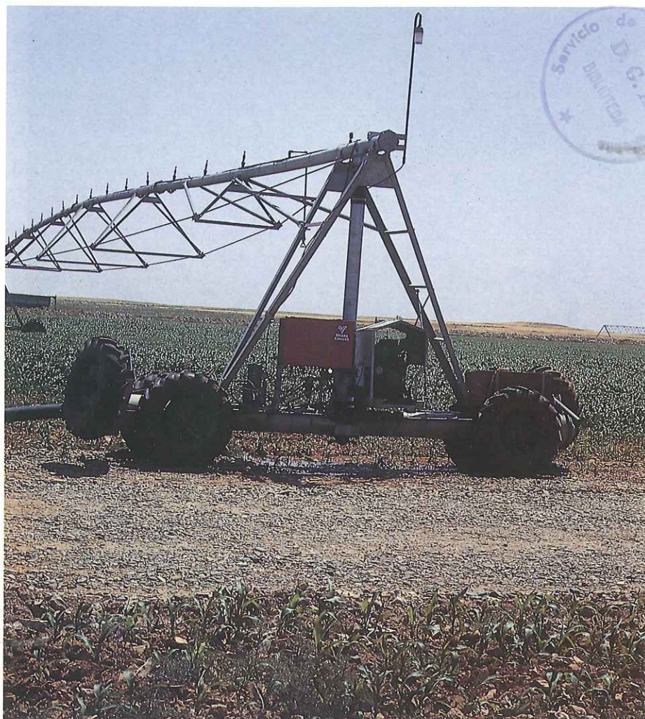
Equipo motriz de un ramal autotransportado con traslación (máquina lateral).
