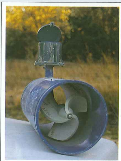
Contador volumétrico. El paso del agua hace girar la hélice y el caudal se registra en el contador situado en la parte superior.
