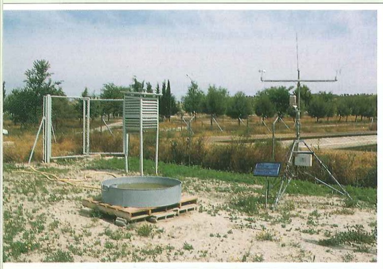
Estación agrometeorológica. Instrumentación manual y electrónica instalada en Monegros.
