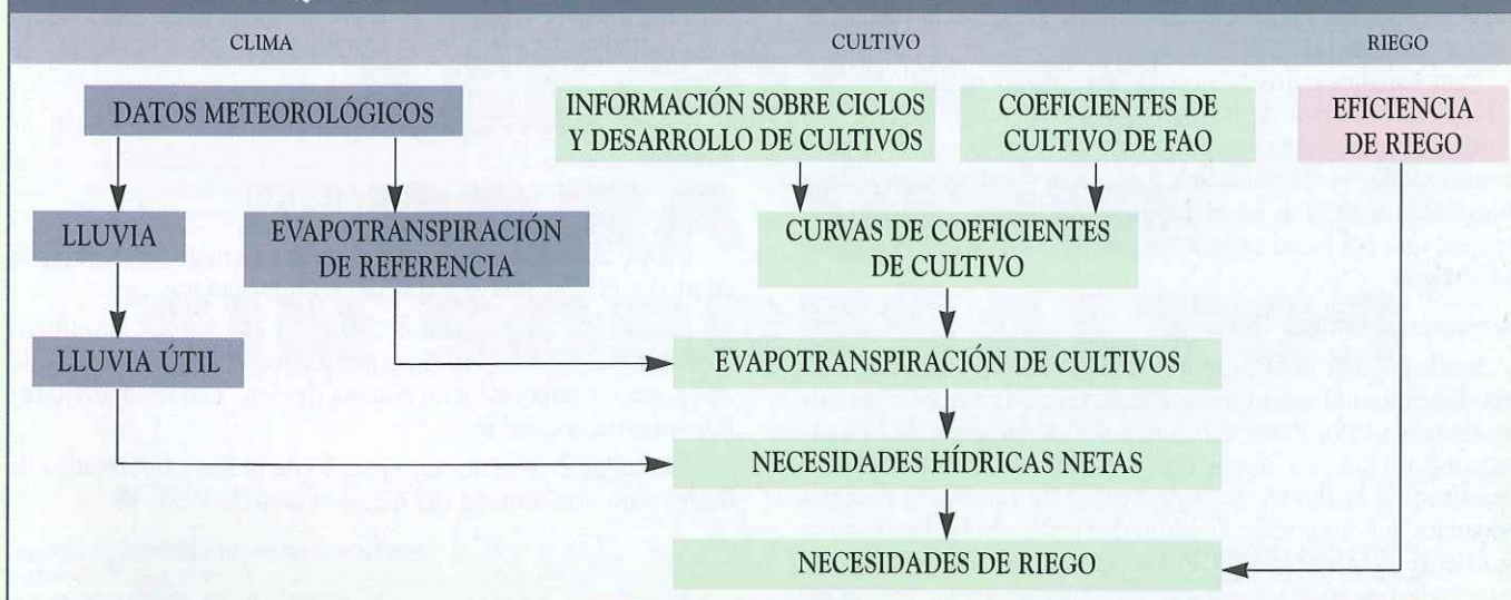
FIGURA 1. ESQUEMA DEL PROCEDIMIENTO PARA CALCULAR LAS NECESIDADES DE RIEGO DE LOS CULTIVOS
