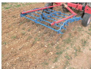
Figura 1 a.- Grada de varillas flexibles utilizada en azafrán.
