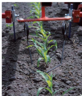
Figura 1 c.- Escardador de torsión utilizado en maíz.
