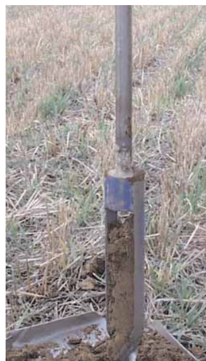
Foto 5: Detalle del muestreo en la capa superficial del suelo.
