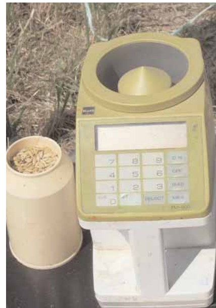
Foto 3: Medidor portátil de humedad de grano.
