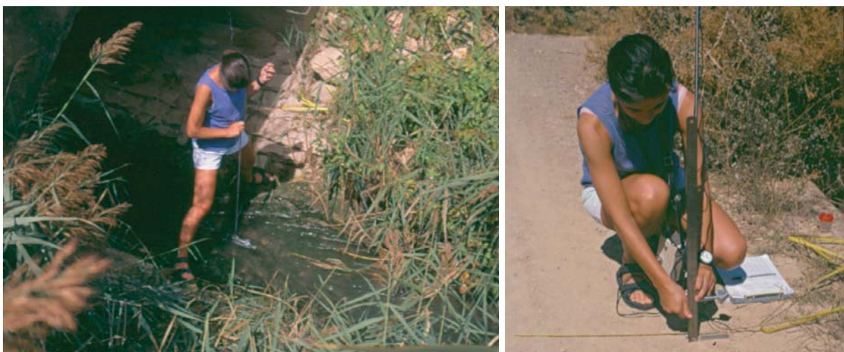
Figura 3. Medida del caudal en cauces naturales mediante el uso de molinete.
