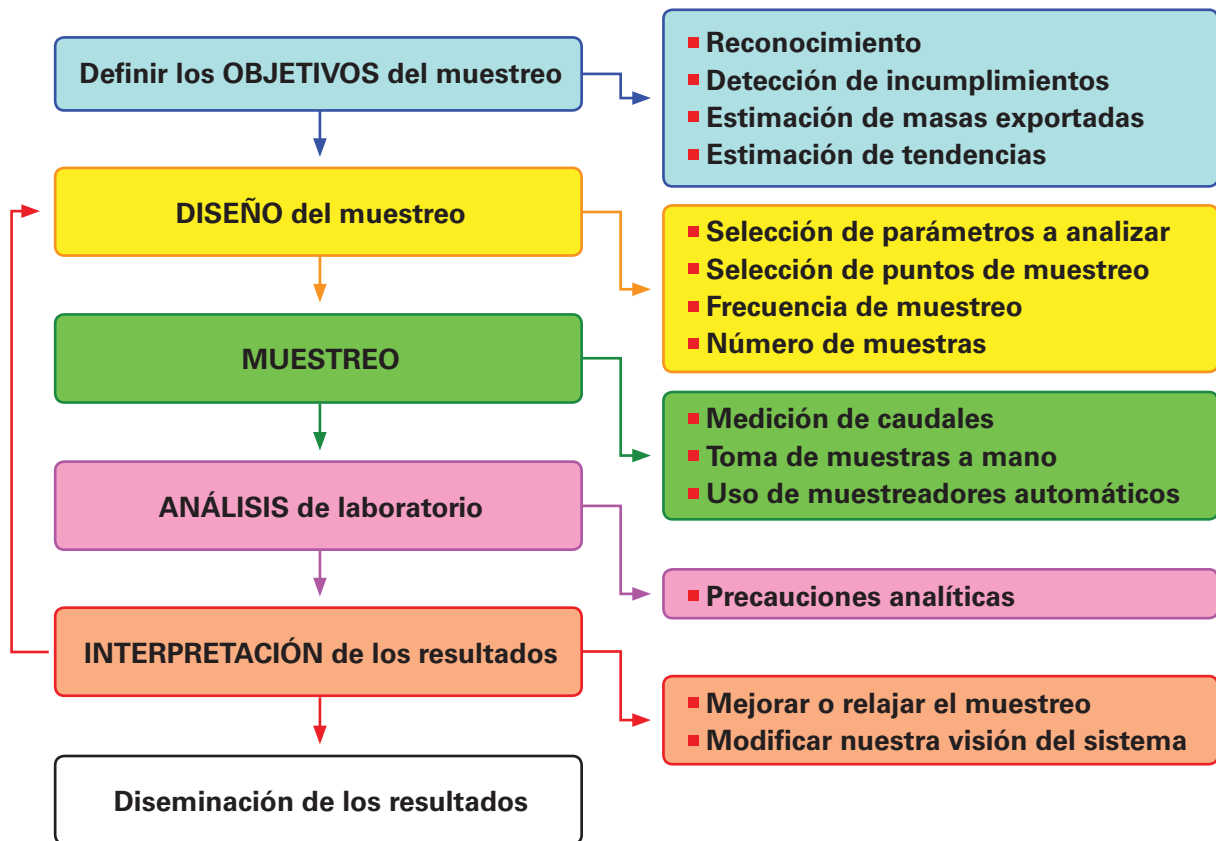
Figura 1. Pasos a seguir en la definición y ejecución de un plan de muestreo de las aguas de retorno de riego.
