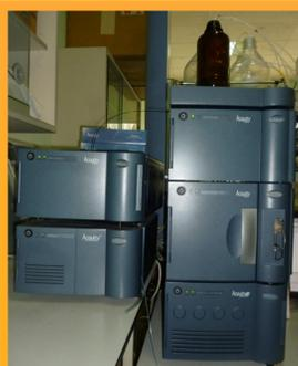
Fig. 3. Procedimiento de extracción e identificación de capsicinoides a partir de frutos de pimiento 'Malagueta'. (A) Método de extracción de capsinoides mediante ultrasonidos; (B) Equipo UPLC-UV utilizado para la identificación de capsicinoides.
