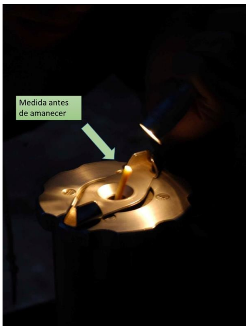
Figura 3. Medida de potencial hídrico antes de amanecer
