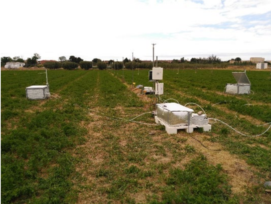
Dispositivo empleado para monitorizar los flujos de emisión a intervalos horarios en la parcela de alfalfa mediante dos cámaras automáticas y un equipo fotoacústico INNOVA 1412i.
