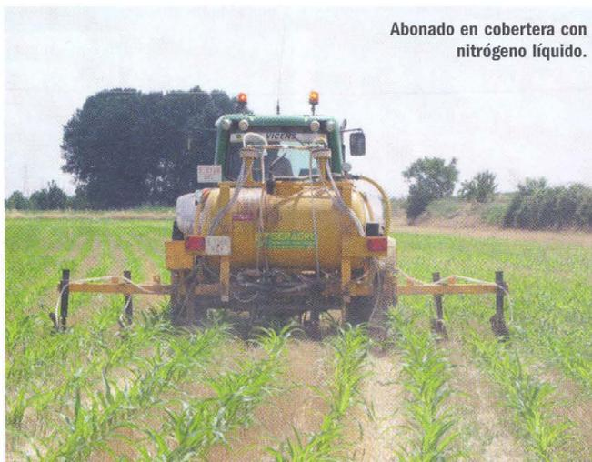
Abonado en cobertera con nitrógeno líquido.
