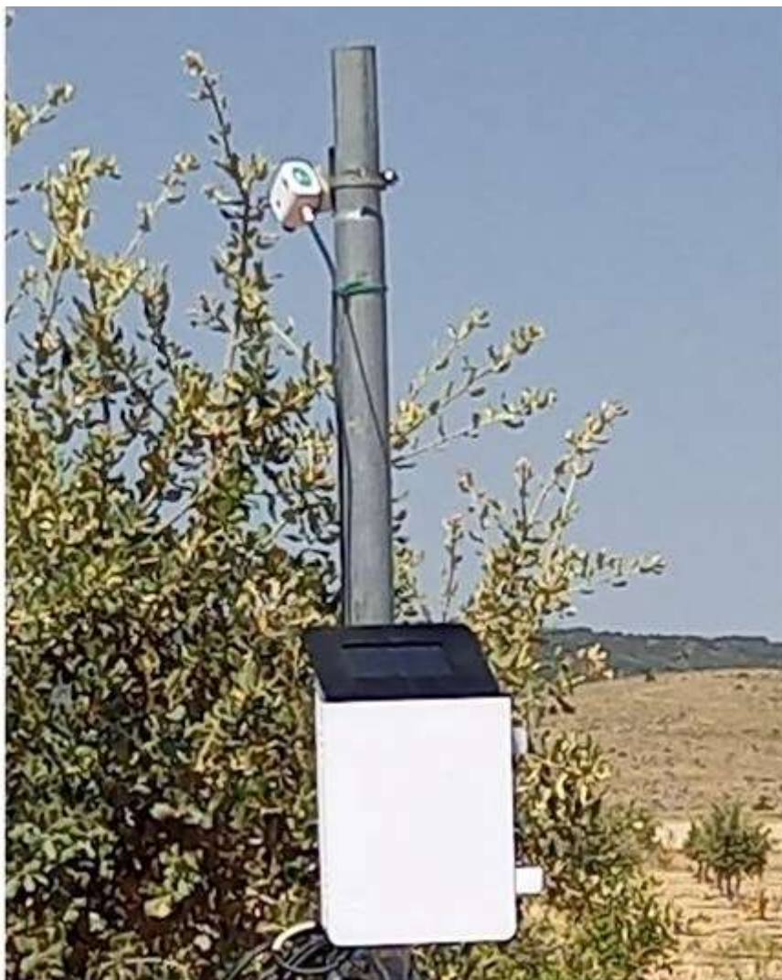
Figura 2. Sensor para la medida de PRI en una copa de encina (parte superior de la foto) conectado a un datalogger que almacena y envía los datos a la nube para su posterior visualización, descarga y análisis (parte inferior de la foto).
