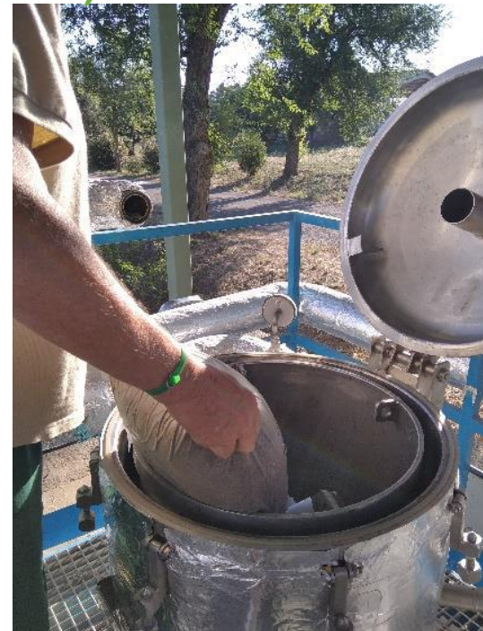
Llenado del vaso extractor con muérdago seco
