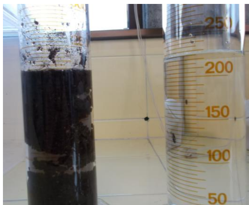
Figura 2. Ilustración del segundo paso del protocolo de medida de la porosidad del suelo.
