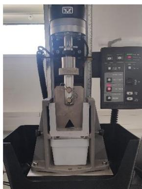
*Fotografía 6. Máquina Instron para la realización del método Warner-Bratzler.*
