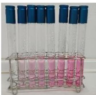
*Fotografía 7. Recta patrón para la determinación de la oxidación lipídica.*
