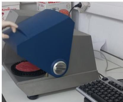
*Fotografía 5. Determinación composición química con espectrómetro de infrarrojo cercano*
