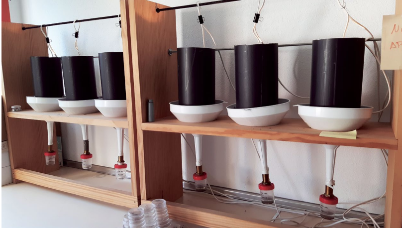
Foto 4. Dispositivo para extraer los microartrópodos contenidos en las muestras de suelo.
