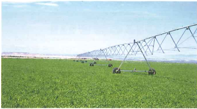
Ranger. Las máquinas de riego por aspersión se están implantando en los nuevos regadíos aragoneses. Esta foto corresponde a una máquina en el regadío de Quinto.
